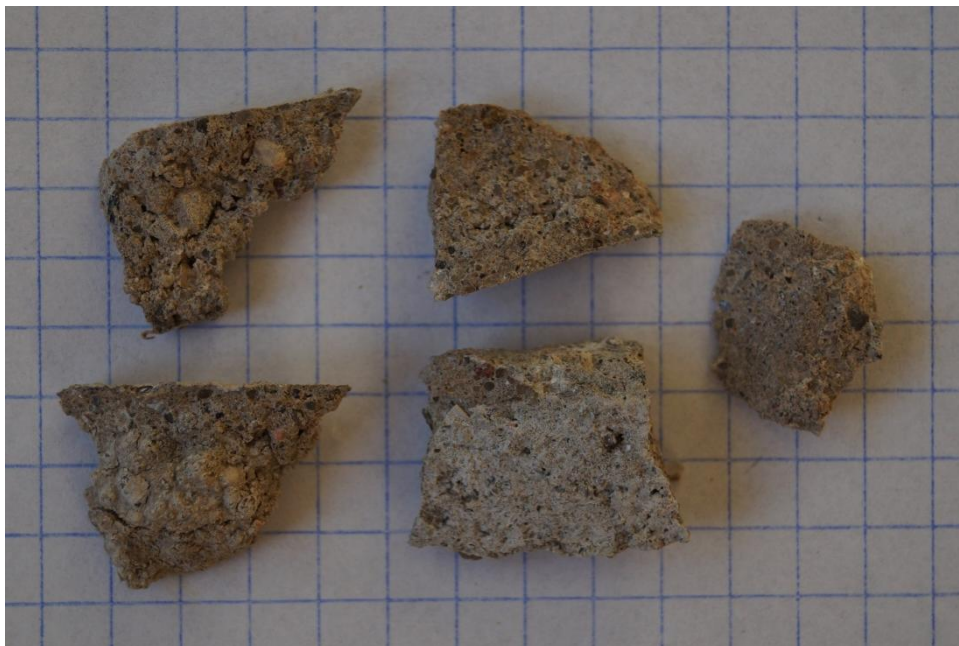
Fot. 92 (wyk. mgr W. Tomaszewski): Zestawienie próbek zapraw, z których wykonano 2 wsporniki podtrzymujące płytę balkonową. Próbki poddano analizie makroskopowo – organoleptycznej.
