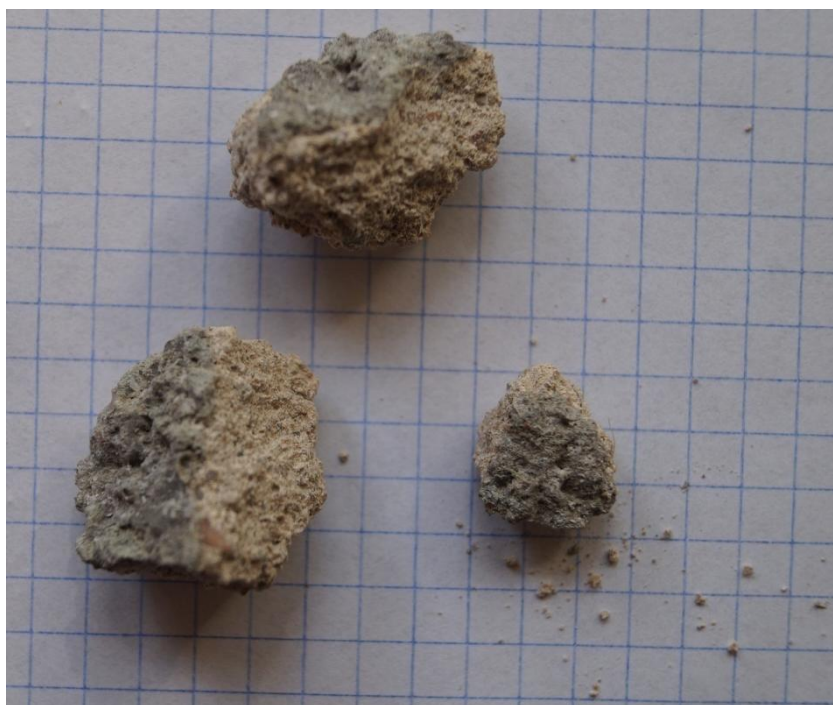
Fot. 75 (wyk. mgr W. Tomaszewski): Fotografia zestawienia pobranych próbek oryginalnego tynku występującego bezpośrednio na murze z czerwonej cegły. Widoczne są również warstwy zwartego szarego wtórnego tynku w postaci tzw. baranka . Próbki poddano analizie makroskopowo – organoleptycznej.
