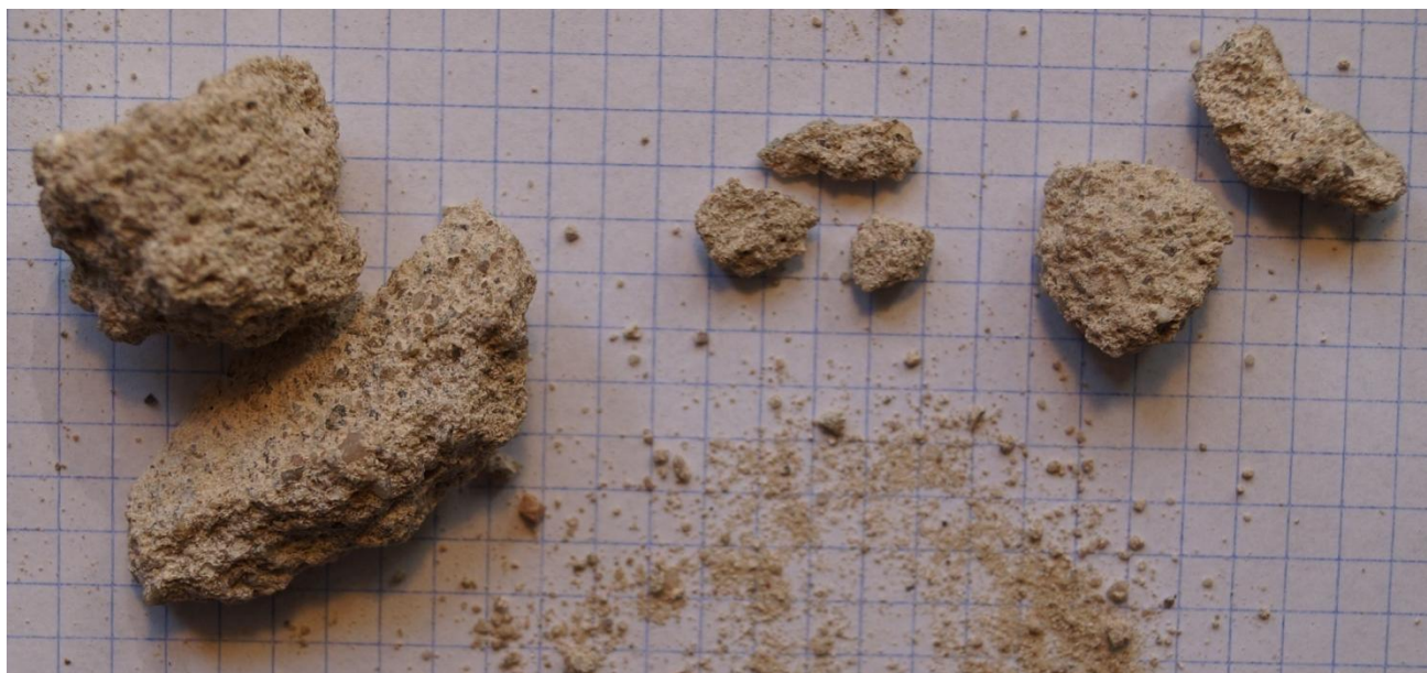
Fot. 76 (wyk. mgr W. Tomaszewski): Fotografia zestawienia pobranych próbek oryginalnego tynku występującego bezpośrednio na murze z czerwonej cegły. Próbki poddano analizie makroskopowo – organoleptycznej.
