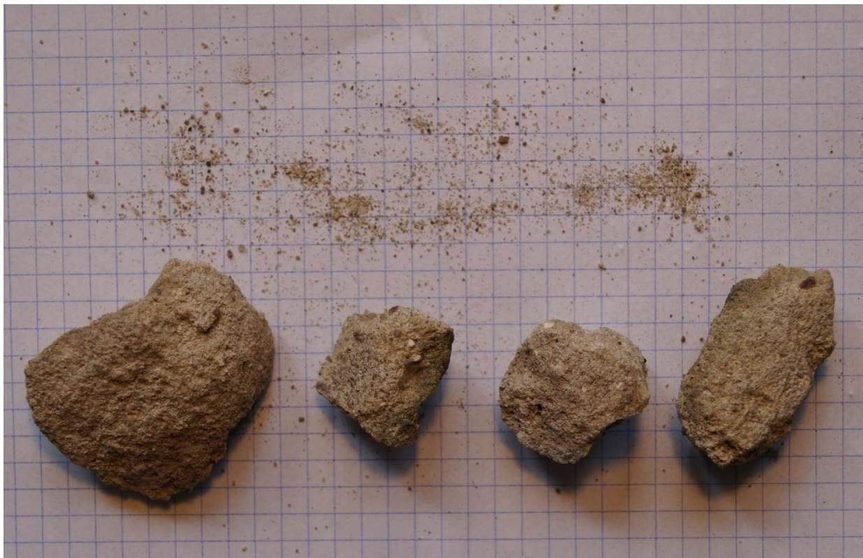
Fot. 71 (wyk. mgr W. Tomaszewski): Fotografia zestawienia pobranych próbek oryginalnej spoiny, występujących pomiędzy blokami granitowymi. Próbki poddano analizie makroskopowo – organoleptycznej.
