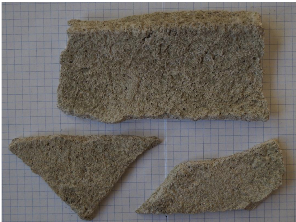
Fot. 86 i 87 (wyk. mgr W. Tomaszewski): Fotografie odspojonych kawałków wtórnej warstwy tynku, obecnej na wierzchu powierzchni profilowanych gzymsów. Jest to współczesny tynk cementowo-wapienny (grubość warstwy: ok. 5mm), który charakteryzuje się wysoką wytrzymałością mechaniczną oraz niską porowatością (jest mocno zbity i zwarty w swojej masie). Warstwa ta jest obecna na wszystkich odcinkach profilowanych gzymsów. Próbkę poddano analizie makroskopowo – organoleptycznej.
