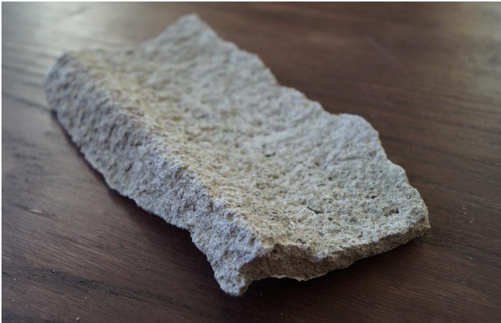
Fot. 88 i 89 (wyk. mgr W. Tomaszewski): Fotografie odspojonych kawałków wtórnej warstwy tynku, obecnej na wszystkich powierzchniach profilowanych gzymsów. Grubość warstwy: ok. 5mm. Próbkę poddano analizie makroskopowo – organoleptycznej.
