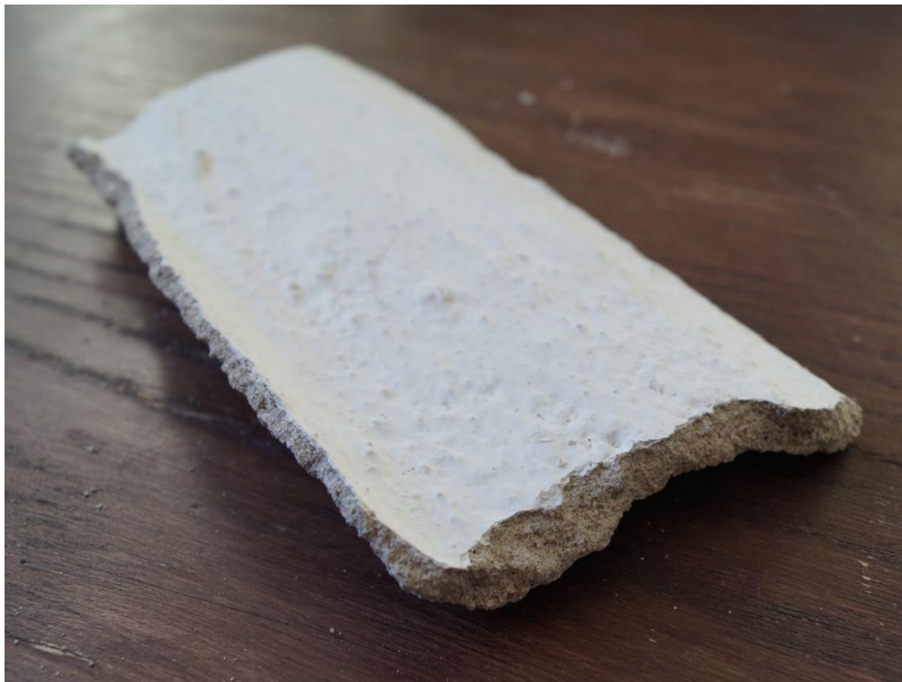
Fot. 88 i 89 (wyk. mgr W. Tomaszewski): Fotografie odspojonych kawałków wtórnej warstwy tynku, obecnej na wszystkich powierzchniach profilowanych gzymsów. Grubość warstwy: ok. 5mm. Próbkę poddano analizie makroskopowo – organoleptycznej.
