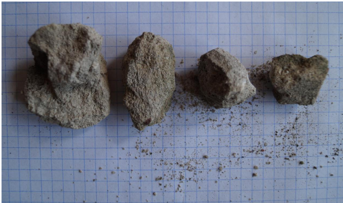
Fot. 70 (wyk. mgr W. Tomaszewski): Fotografia zestawienia pobranych próbek oryginalnej spoiny, występującej pomiędzy blokami granitowymi. Próbki poddano analizie makroskopowo – organoleptycznej.
